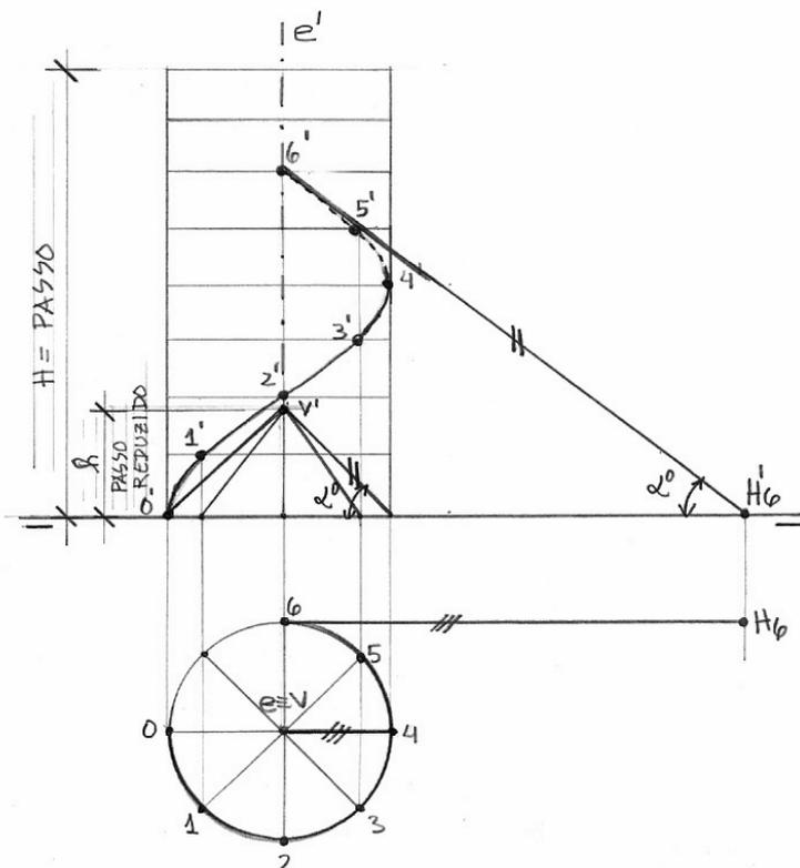
Passamos então para a épora, construindo em épora o cone das tangentes com base coincidente com a base do cilindro núcleo e com a altura igual ao seu passo reduzido (h) já calculado. (ver figura ao lado)
