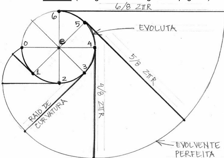
Na Hélice Cilíndrica Normal (HCN), (exemplo ao lado), a sua evolvente é dita perfeita porque a diferença de comprimento das tangentes (no caso ao lado se tratam das subtangentes em projeção horizontal sobre o plano de seção reta), é igual ao arco de curva compreendido entre dois de seus pontos de tangência. Isto ocorrerá tanto no espaço como em projeção que é a maneira expressa na figura ao lado.
